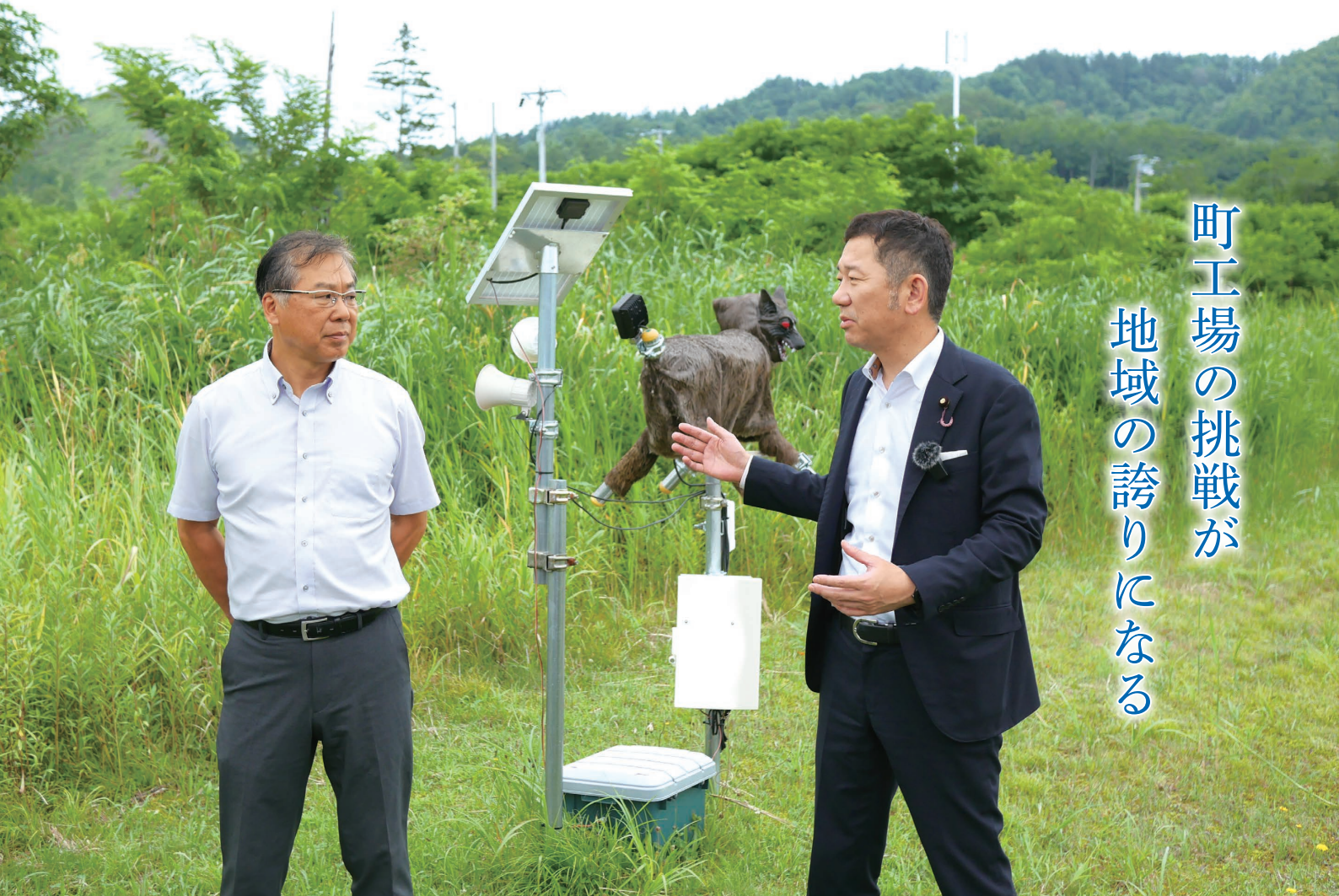
屋外に設置されている「モンスターウルフ」。太陽光発電と充電バッテリーを使用し、屋外のどこにでも設置でき、電気柵に比べてメンテナンスの手間や維持管理のコストが少ないメリットもある
